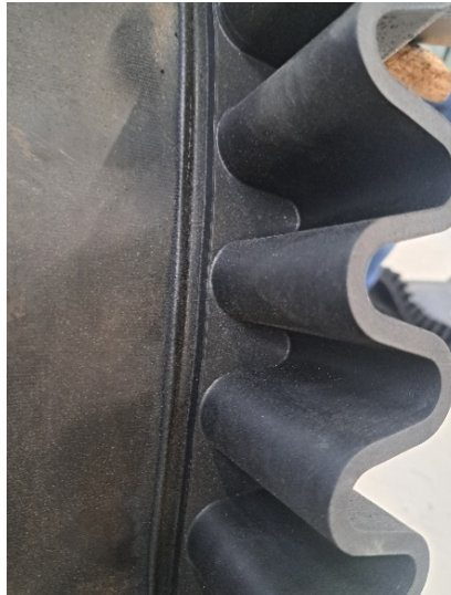
Fot. 7. Falbana wulkanizowana metodą na gorąco
