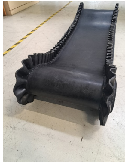
Fot. 9. Taśma z falbanami wulkanizowanymi metodą na gorąco
